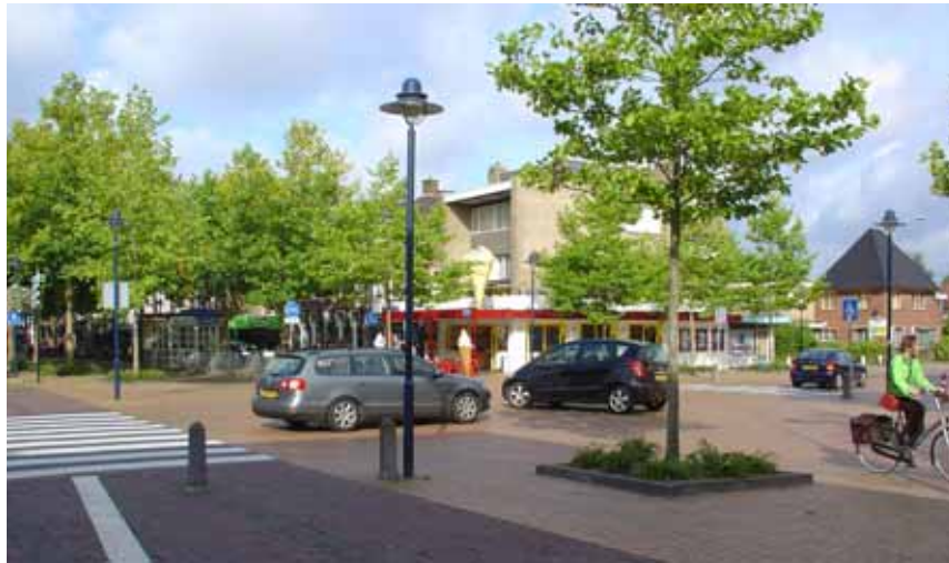
Drachten, Holland: Rechts-vor-Links statt Ampel-Kreuzung mit 15.000 Kfz, 7.000 Radfahrern pro Tag (eigenes Foto)
