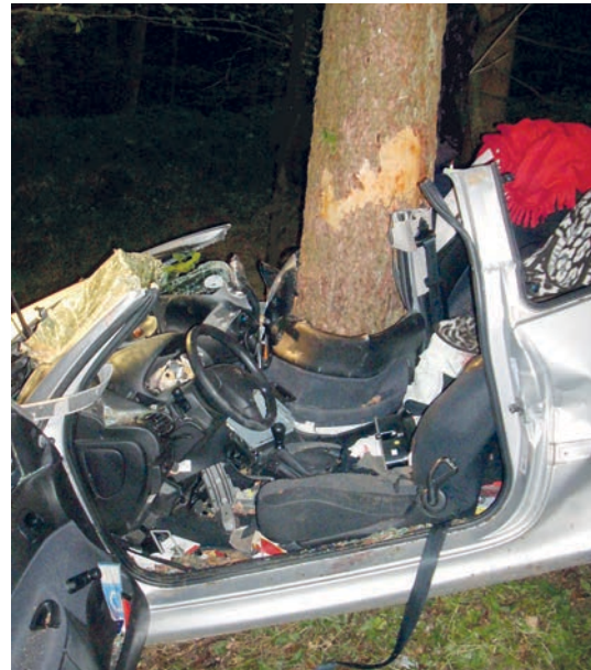
Abbildung 5: Rechtsseitiger Baumanprall eines Pkw; schwerstverletzter Fahrer auf der stoßabgewandten Seite (Quelle: Feuerwehr)
