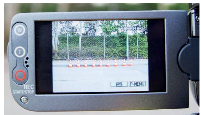
Abbildung 30: Aufnahmeposition: videogestützte Auswertung des Bremsbeginns
