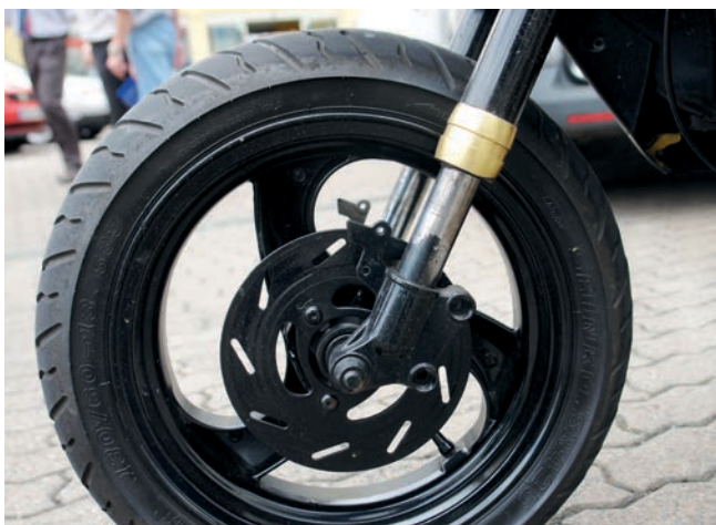
Abbildung 11: Vorderradbremisanlage mit demontiertem Bremssattel und lackierter Bremsscheibe
