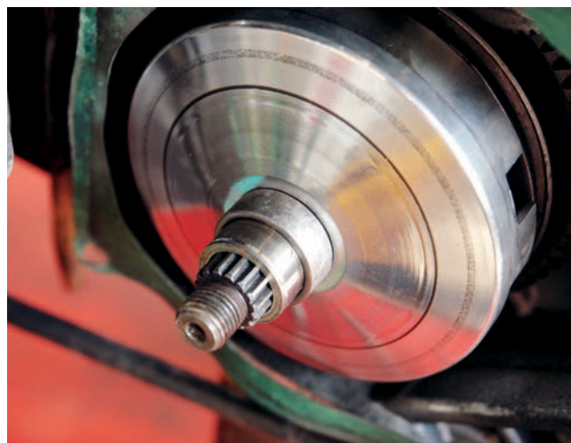
Abbildung 17: An der vorderen Welle angebrachter Distanzring
