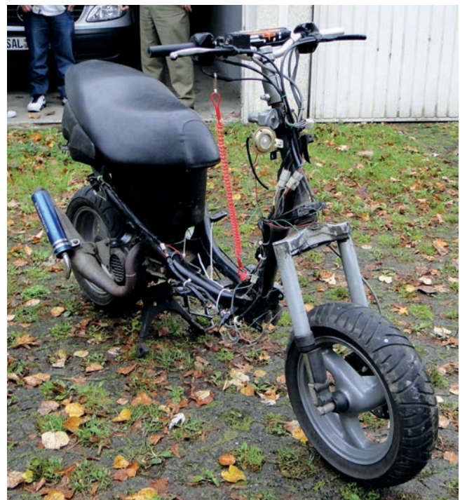
Abbildung 6: Roller, an dem sämtliche Verkleidungs- und Anbauteile entfernt wurden
