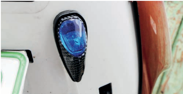
Abbildung 8: Ausgetauschter Fahrtrichtungsanzeiger mit blauer Streuscheibe
