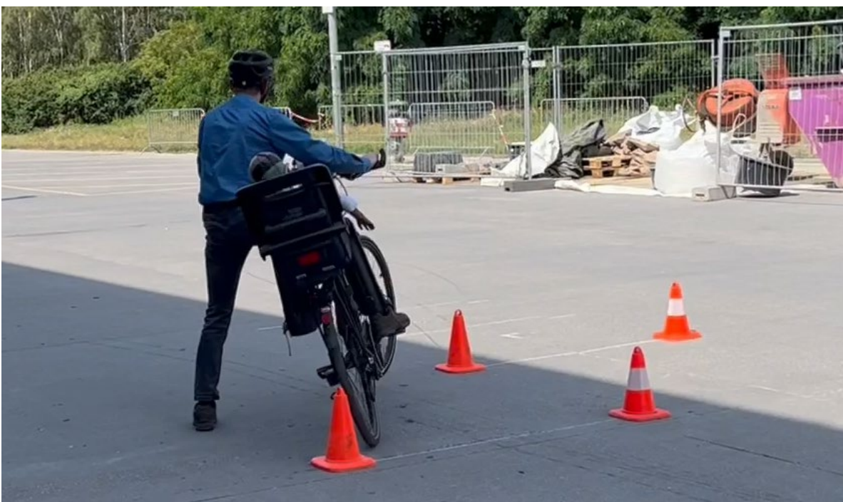
Abbildung 88: Kindersitz kippt nach vollendeter Bremsung
