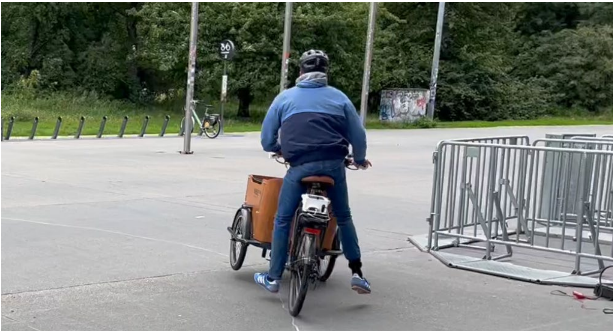
Abbildung 94: Lastenrad kippt während der Kreisfahrt nach außen
