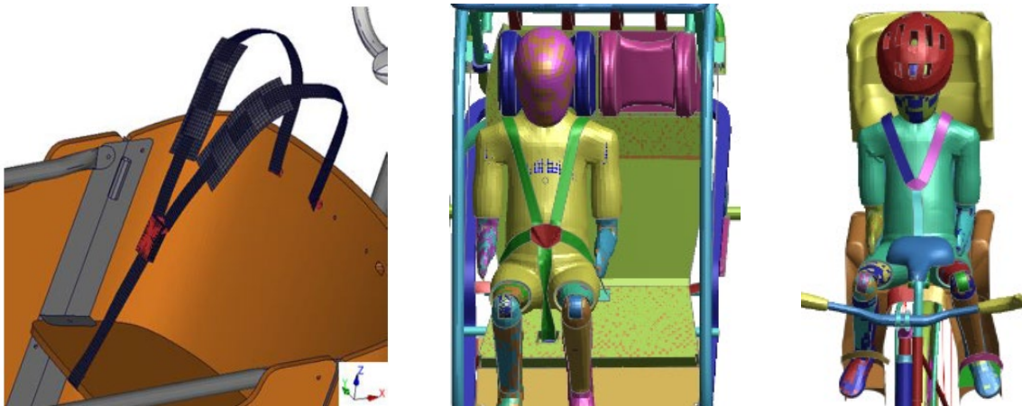
Abbildung 140: Gurtsysteme aller Transportvarianten
