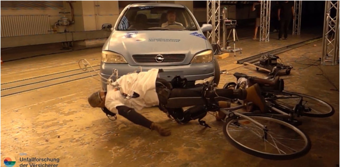
Abbildung 124: Fahrrad mit Kindersitz prallt nach Abbiegeunfall auf dem Boden auf
