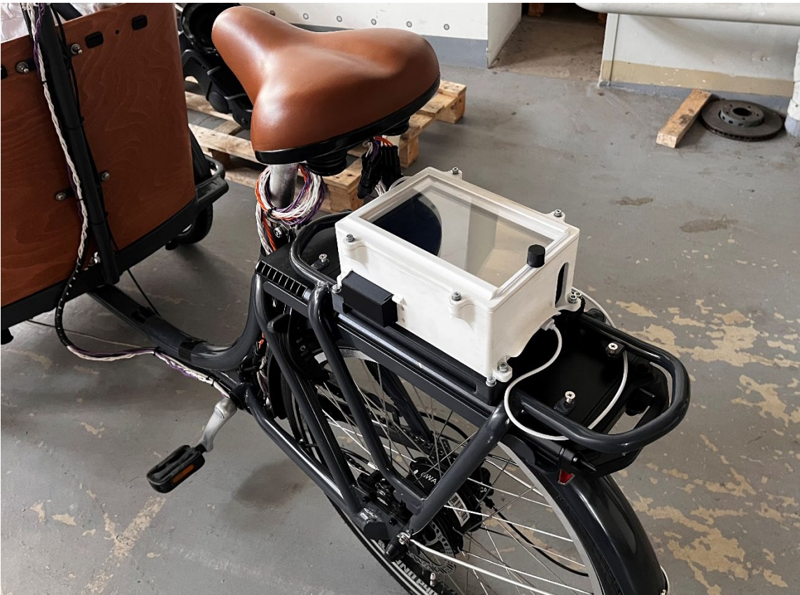
Abbildung 82: Anbringung der Messbox auf dem Lastenfahrrad
