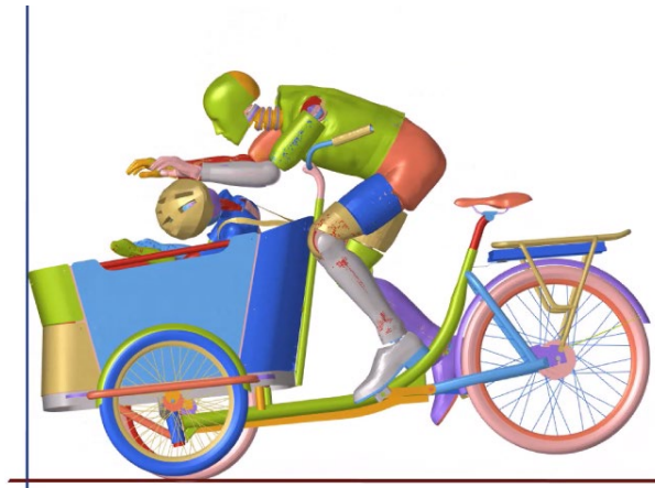
Abbildung 144: Interaktion beider Dummys aufgrund der Vorverlagerung des H350-Dummys im Frontalaufprall mit der starren Wand
