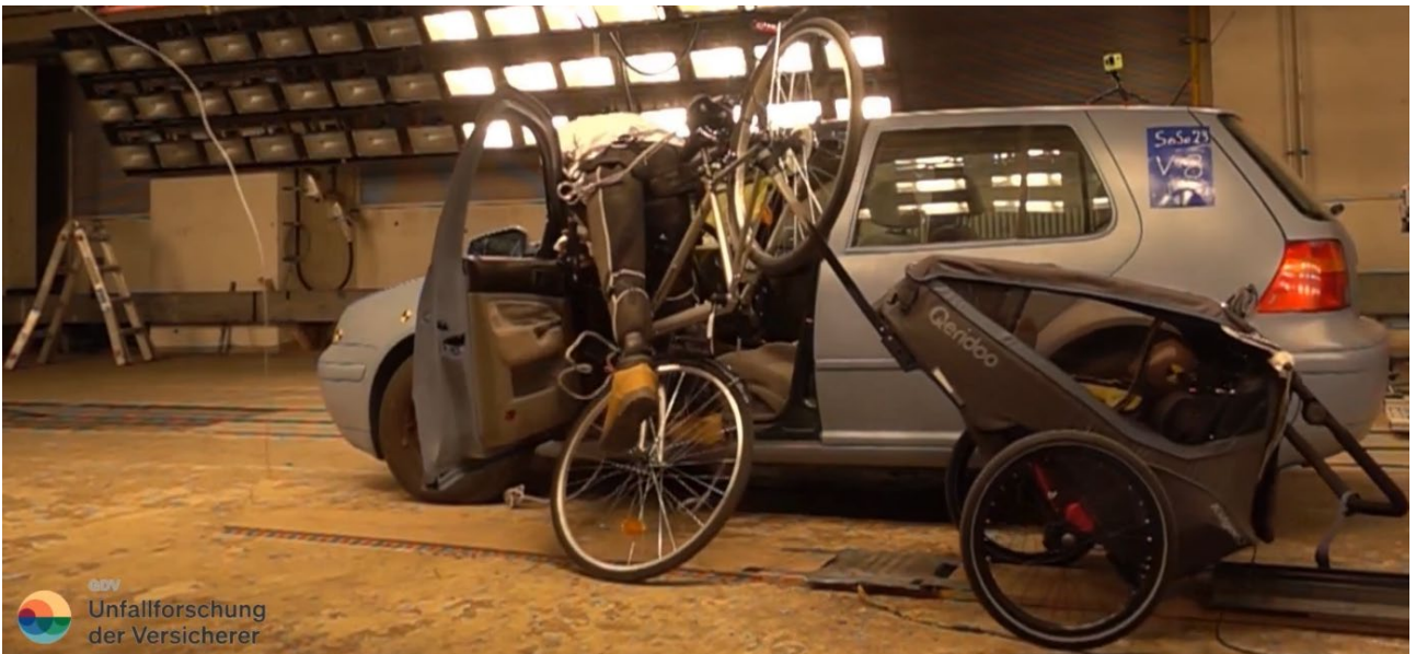
Abbildung 119: Dooring mit Anhänger und 60 ° Türöffnungswinkel
