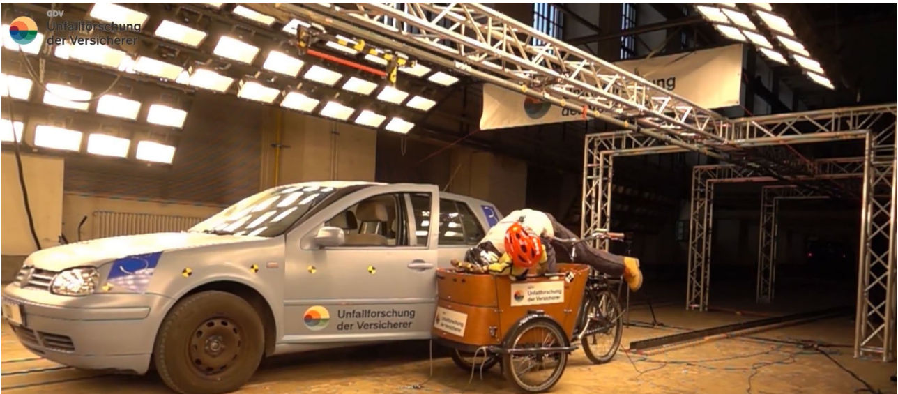
Abbildung 121: Dooring mit Lastenrad und 20 ° Türöffnungswinkel
