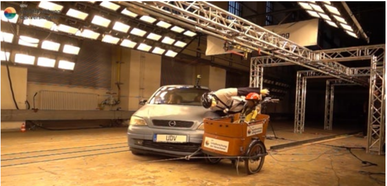
Abbildung 126: Kollision beim Abbiegeunfall mit dem Lastenrad
