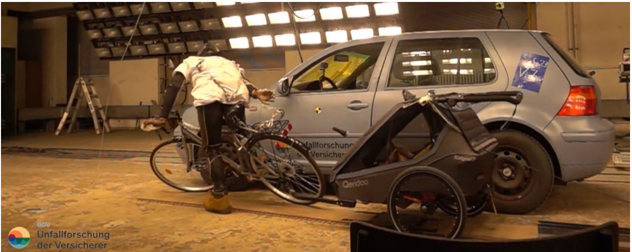
Abbildung 118: Dooring mit Anhänger und 15 ° Türöffnungswinkel
