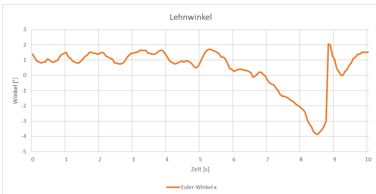
Abbildung 95: Lehnwinkelverlauf eines kippenden Lastenrads in der Kreisfahrt
