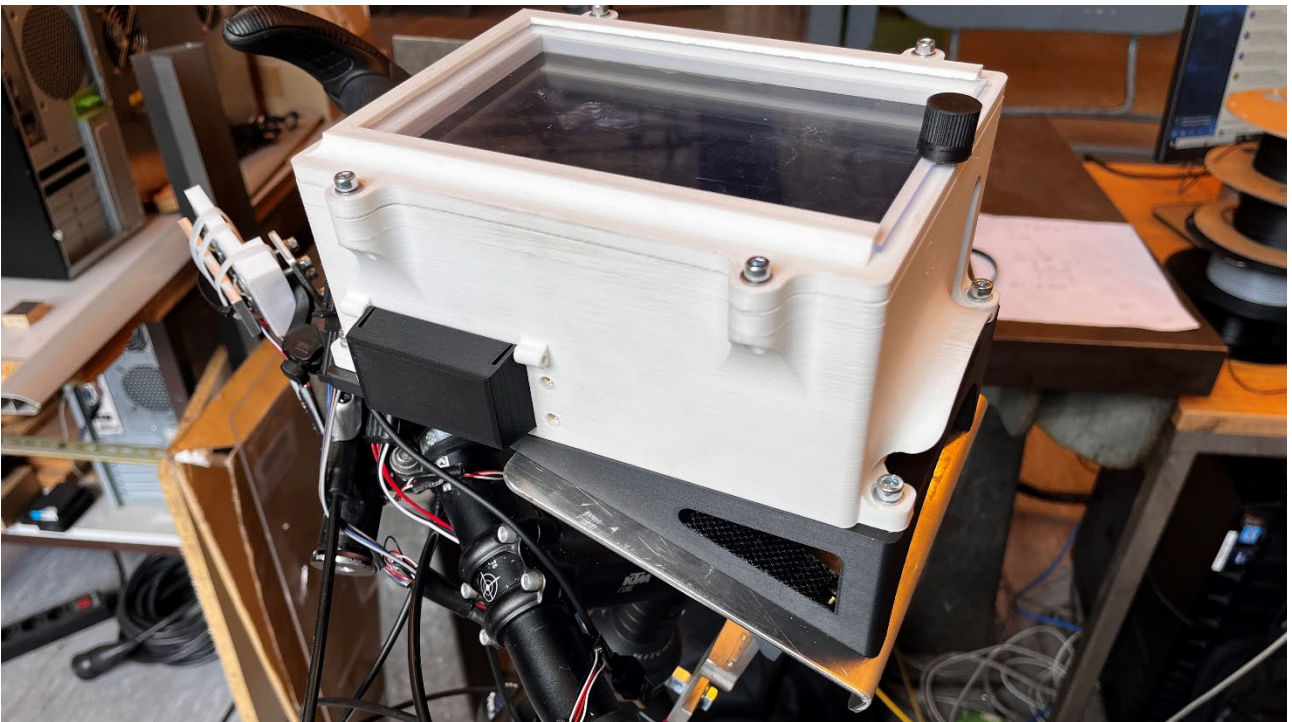
Abbildung 77: Befestigung des Messbox auf dem Messfahrrad
