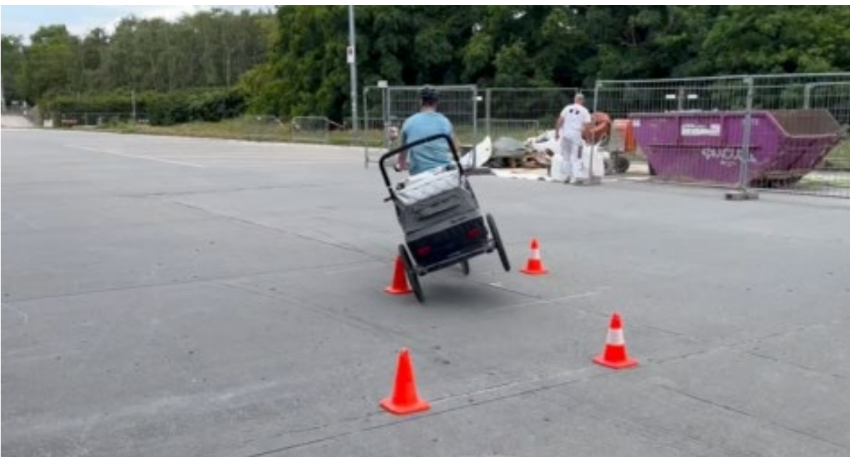
Abbildung 98: Anhänger kippt während des Ausweichmanövers
