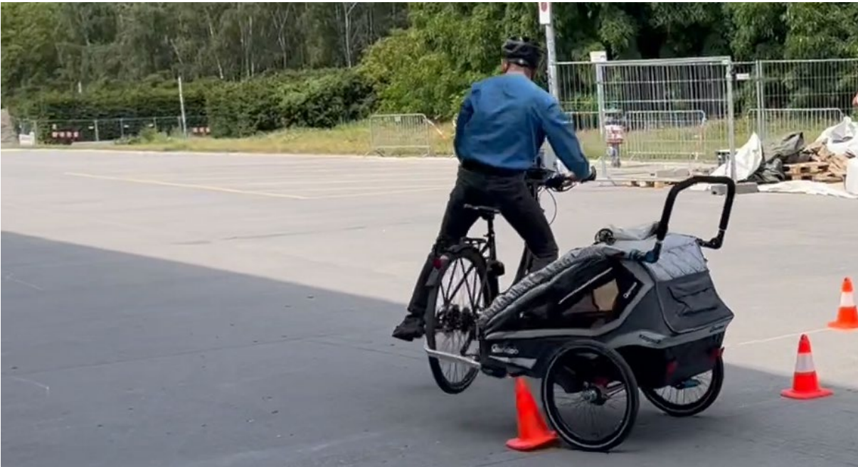
Abbildung 89: Anhänger stellt sich bei der Gefahrenbremsung quer
