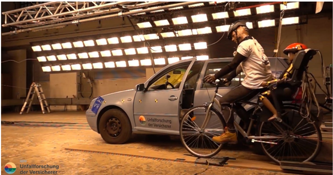
Abbildung 30: Versuchsszenario 2: Dooring-Unfall mit Kindersitz
