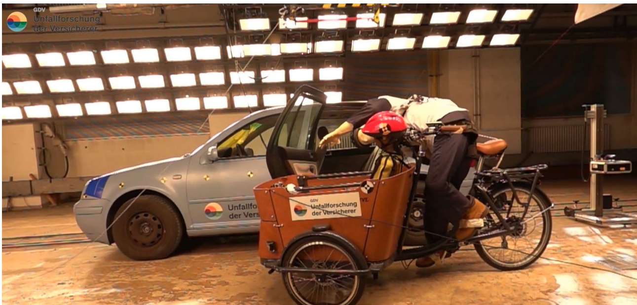
Abbildung 120: Dooring mit Lastenrad und 80 ° Türöffnungswinkel
