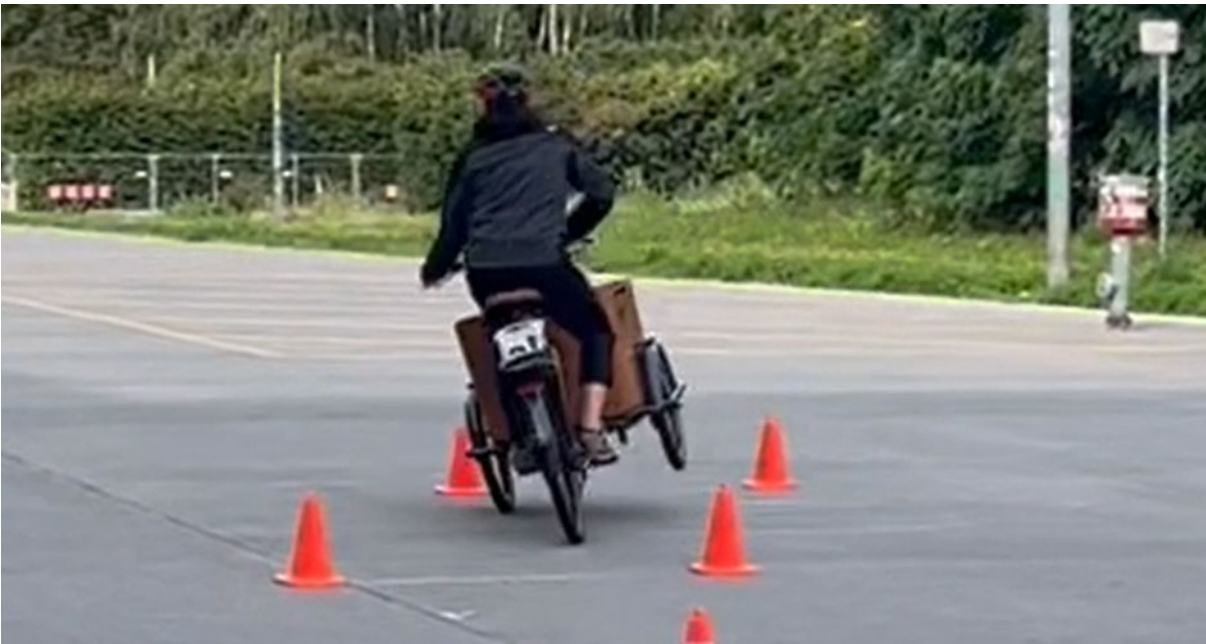
Abbildung 97: Lastenrad kippt während des Ausweichmanövers
