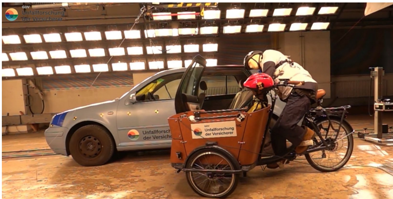
Abbildung 122: Kopf des Kinderdummys schlägt nach Dooring gegen Lenker des Lastenrads
