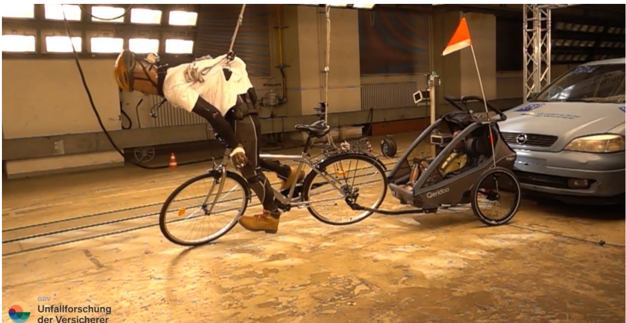
Abbildung 113: Auffahrunfall mit Anhänger, 7 km/h
