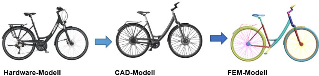
Abbildung 128: Entwicklung vom Hardwarefahrrad zum FEM-Modell [RAW24]
