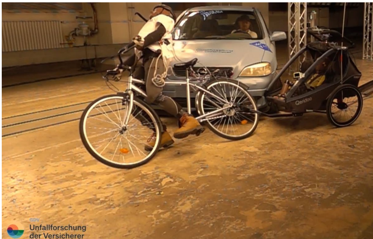
Abbildung 125: Kollision beim Abbiegeunfall mit Anhänger
