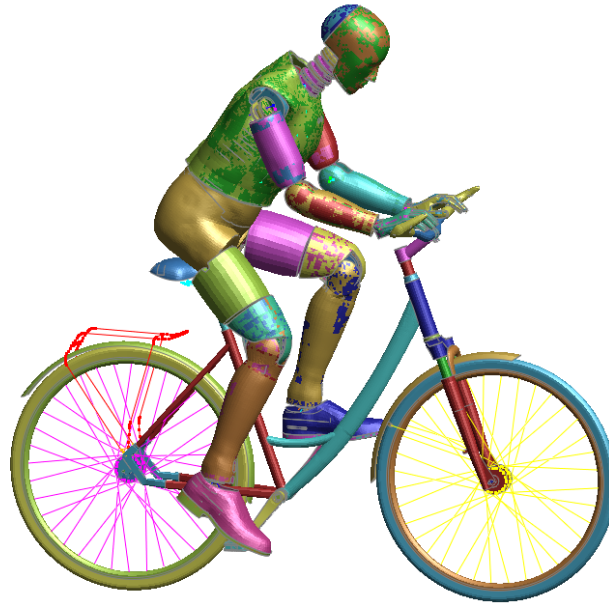
Abbildung 132: FEM-Modell bestehend aus Trekkingrad und HIII-Dummy
