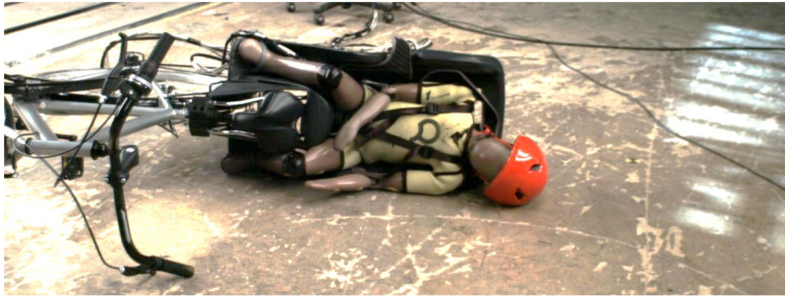
Abbildung 111: Umkippen aus dem Stand (Kindersitz, mit Fahrradhelm)
