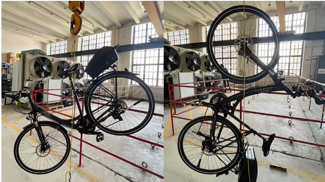
Abbildung 131: Vermessung des Schwerpunktes des physischen Fahrrades
