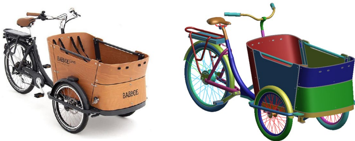
Abbildung 137: Reales Lastenrad und FE-Modell
