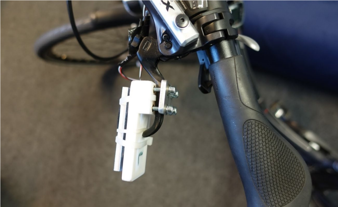
Abbildung 76: Befestigung des Kraftsensors am Bremshebel
