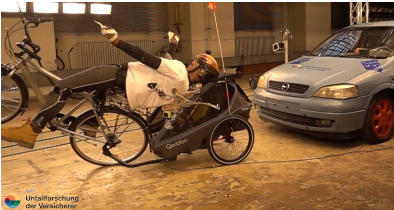
Abbildung 114: Auffahrunfall mit Anhänger, 12 km/h
