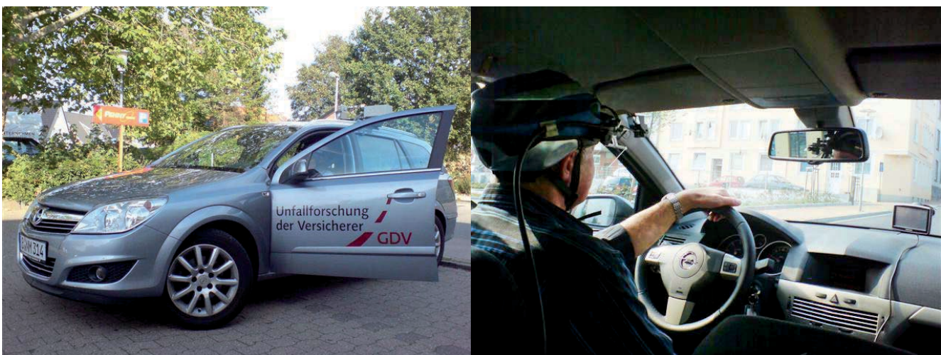
Abbildung 1: Versuchsfahrzeug der Fahrstudie (links) und Proband mit Blickbewegungsmesssystem (rechts)
