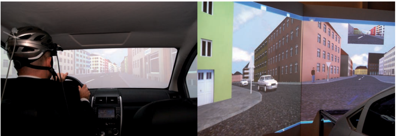
Abbildung 3: Proband im Fahrstudie mit Blickbewegungsmesssystem (links) und innerstädtische Szenerie (rechts)
