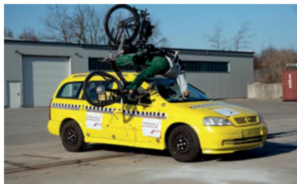
Abb. 13: Zusammenstoß zwischen stehendem Fahrzeug und in die Seite fahrendem S-Pedelec ( $v=44$  km/h)
