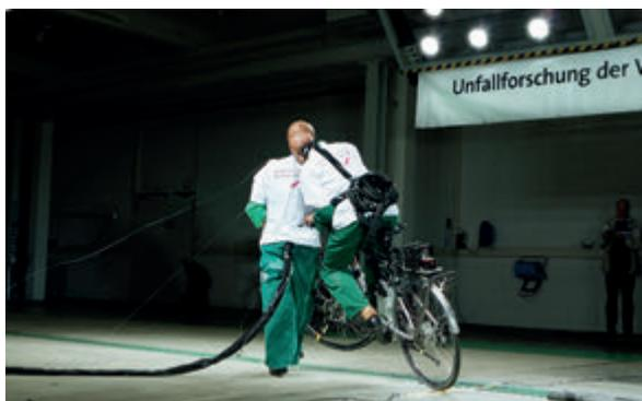
Abb. 14: Zusammenstoß zwischen S-Pedelec (v=25 km/h) und Fußgänger
