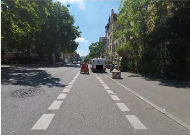
**Abbildung 141:** Fehlender Sicherheitstrennstreifen
