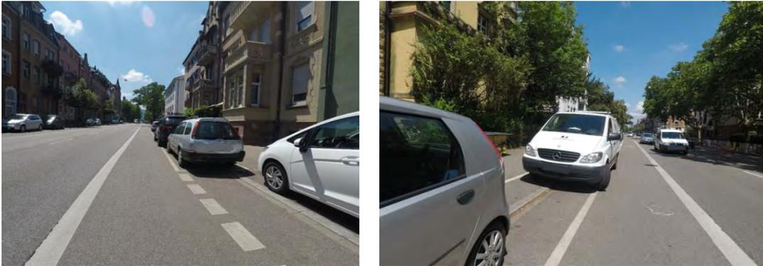
**Abbildung 56:** Fehlender Sicherheitstrennstreifen
