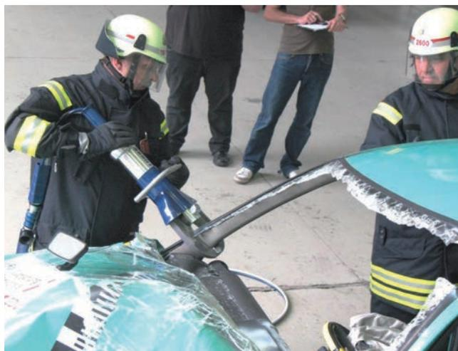
**Abbildung 5:** Durchtrennen der A-Säule mittels Rettungsschere
