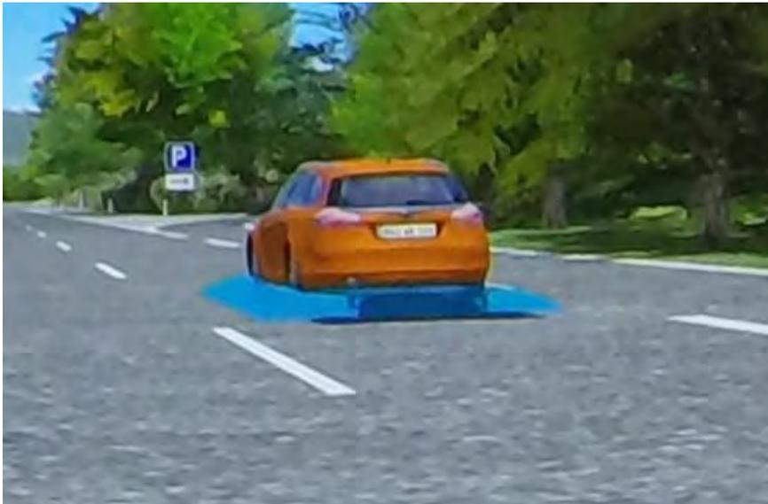
**Abbildung 2:** Kennzeichnung der hochautomatisierten Fahrzeuge mit Hilfe einer lichtbasierten Markierung. Das hochautomatisierte Fahrzeug erscheint so in einem gut sichtbaren Lichtrechteck.
