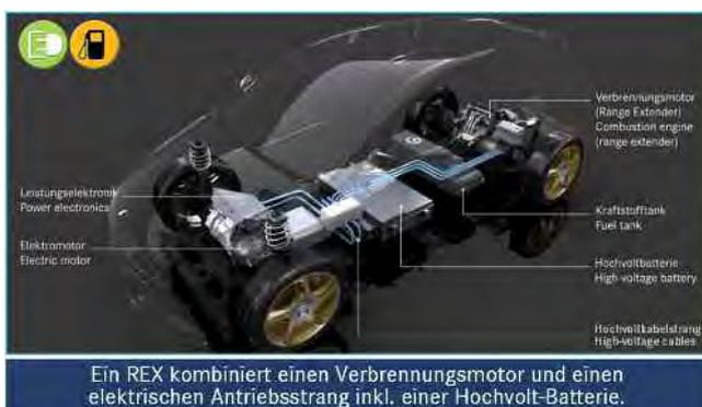
Abb. 1: Der Range Extender kombiniert die Vorteile beider Antriebe
