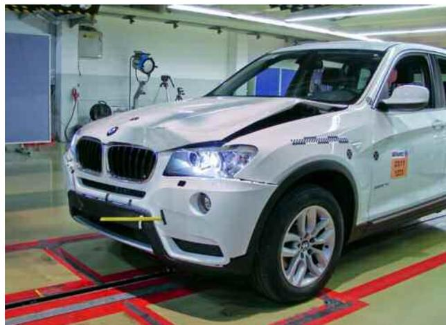
Abb. 1: Typische Schadenumfänge nach einen 15 km/h RCAR Frontcrash
