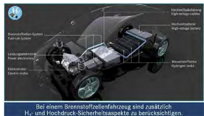
Abb. 2: Aufbau eines Brennstoffzellenfahrzeugs
