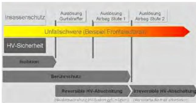
Abb. 5: Sicherheitskonzept zum Schutz vor Stromschlägen nach einem Unfall
