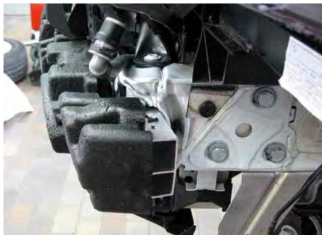
Abb. 2: Typische Schadenumfänge nach einen 15 km/h RCAR Frontcrash
