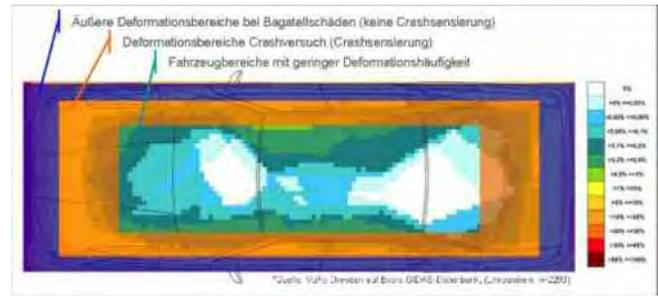
Abb. 3: Deformationshäufigkeit einzelner Fahrzeugbereiche im Realunfall
