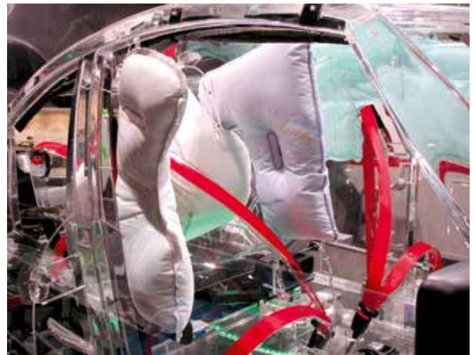
Wichtige Komponenten für den Insassenschutz: Sicherheitsgurte und Airbags.
